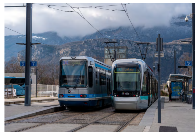
Deux générations de tramway au terminus de Pont-de-Claix l'étoile. A gauche une rame TFS mise en service à partir de 1987 et à droite, une rame Citadis 402 plus longue et plus capacitaire arrivée sur le réseau à partir de 2005.
