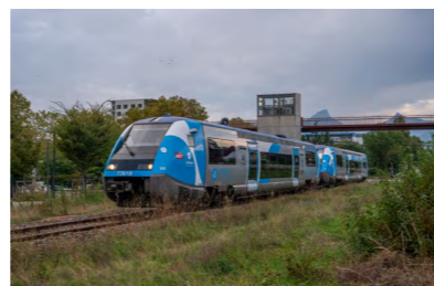
Sur la ligne Grenoble - Gap les rames nommées ATER ou X73500 ne possèdent que deux crochets pour l'emport des vélos.
