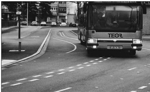
Balisage au sol du système "VISÉE" développé par Matra Transports et Renault Véhicules Industriels
