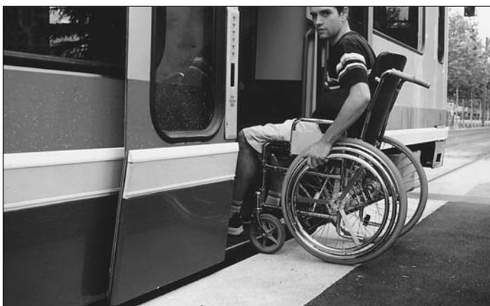
gie porteur à essieux coudés. Ainsi, on peut laisser le libre passage entre les roues sur une longueur de 17 m sur les 29,30 m du tram, le plancher étant alors bien situé à 35 cm du sol seulement ! Les deux boggies extrêmes conservent une hauteur de plancher à 85 cm du sol pour pouvoir y installer les moteurs.
