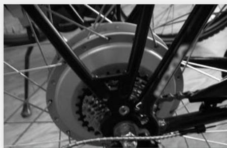
Puis les moteurs sans balais « brushless », localisés dans le moyeu de la roue arrière ont simplifié la chaîne d'entraînement avec une électronique plus sophistiquée.
