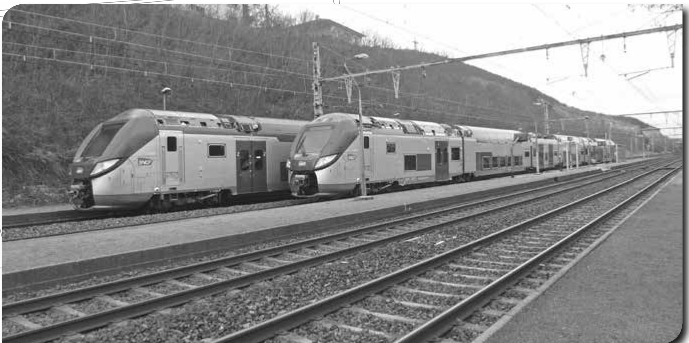
Un exemple de 4 voies au Nord de Lyon : Deux TER omnibus sur la ligne Vienne - Villefranche-sur-Saône effectuent leur arrêt en gare de Couzon-au-Mont-d'Or. Les deux autres voies sont utilisées par les trains rapides (par exemple, les TGV Rhin-Rhône et les TER Lyon-Dijon-Paris). Ainsi les conflits de circulation entre trains lents et trains rapides sont inexistantes.
